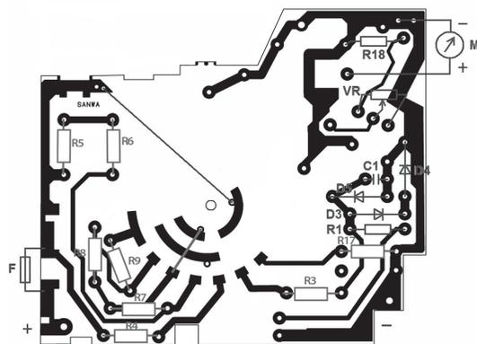
□**交流電圧計** 交流電圧計の倍率器はDCVと共用のため取り付け済みです。整流用ダイオードD1、D2を取り付けます。
