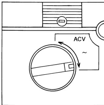
1. レンジ切り換えつまみをACVレンジの中で最適なレンジに合わせます。
