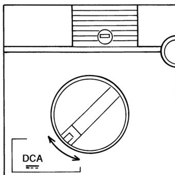
1. レンジ切り換えつまみをDCAレンジの中で最適なレンジに合わせます。
