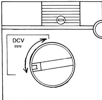
1. レンジ切り換えつまみを DCVレンジの中で最適なレンジに合わせます。
