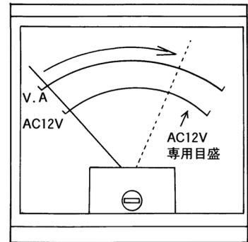
3. メータの振れをV・A目盛で読み取ります。(ただしAC 12 Vレンジは、AC 12 V専用目盛で読み取ります。)
