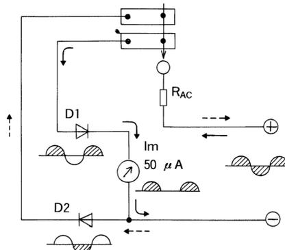
図5-4 交流電圧計原理図
