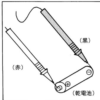
2. 赤のテストピンを被測定物のプラス側に、黒のテストピンをマイナス側にあてます。
