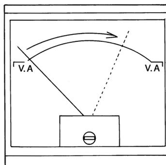
3. 被測定回路の電源をONにしメータの振れをV・A目盛で読み取ります。
