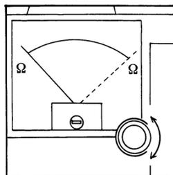
3. テストピンをショートさせたまま0 $\Omega$ 調整つまみを回し、 $\Omega$ 目盛の0に合わせます。
