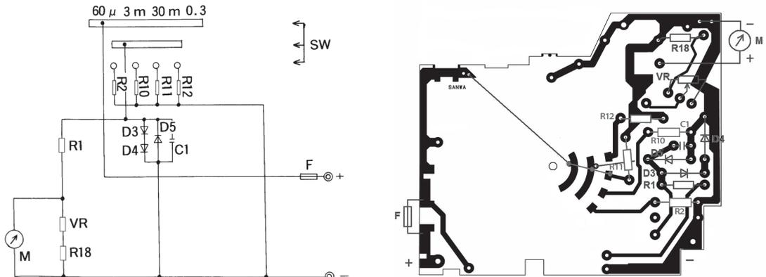
□**直流電圧計** R3 (3 V)、R4 (12 V)、R17を取り付け、交流電圧計の倍率器の共用のR5 ~ R9を取り付けます。
