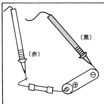
2. 被測定回路の電源をOFFにしてから回路を切り離し、赤テストピンをプラス側、黒テストピンをマイナス側に接続します。
