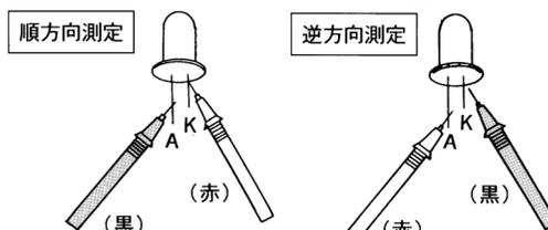
・測定電圧：約3V (内蔵電池)
