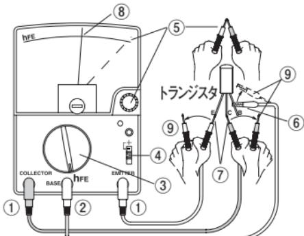
● 測定時のベース電流は最大で $60\ \mu\text{A}$ 、測定値が大きくなるほど小さくなります。hFE値が500のとき、約 $10\ \mu\text{A}$ です。
