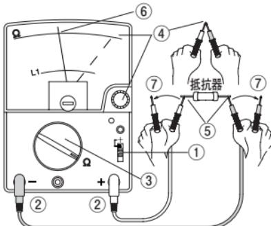
●LI(端子間電流)は抵抗測定時の入力端子+、-間に流れる電流です。本器パネル上、各 $\Omega$ レンジの右側にLIの最大値が付記されています( $80\ \mu A$ 、 $800\ \mu A$ 、 $8\ mA$ 、 $80\ mA$ )。
