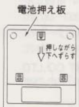
第4図 電池押え板のあけ方
