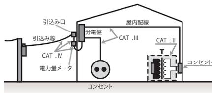
測定カテゴリの電圧は一般的に対地電圧になります。Y結線 480 V や非接地  $\Delta$  結線 480 V の2次側はCAT.Ⅲ 300 V 内となります。
