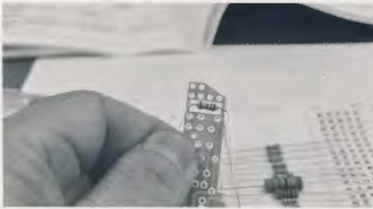
《写真5》ハンダ付け練習基板で抵抗の足曲げ寸法を計る
