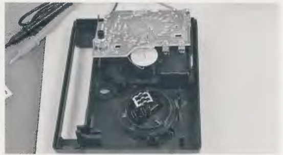
《写真8》スイッチブラシを置き、基板をかぶせる
