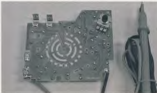
《写真7》基板の配線完了 (プリントパターン面)
