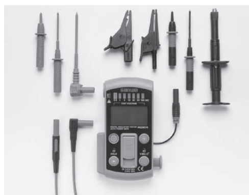
様々なアダプタを付け替えて計測できる
